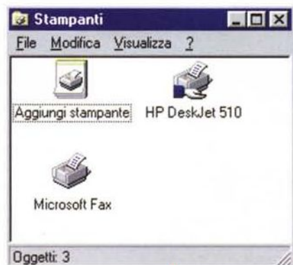
Figura 3 - Il dispositivo "Microsoft Fax" viene visto dal sistema operativo come una stampante. La sua presenza, quindi, viene registrata all'interno della cartella stampanti.
